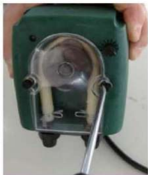
Рисунок 31. Порядок действий при замене перистальтического шланга насоса-дозатора Etatron B3-V PER 1-3 90/260V SANT.
