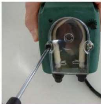
Рисунок 31. Порядок действий при замене перистальтического шланга насоса-дозатора Etatron B3-V PER 1-3 90/260V SANT.
