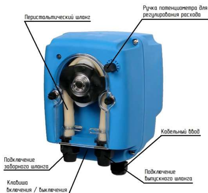
Рисунок 15. Внешний вид и органы управления насоса-дозатора Etatron B3-V PER 1-3 90/260V SANT
